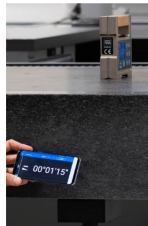
TESA CLINOBEVEL 3 avec un appareil Android pour visualisation de l'écran déporté
